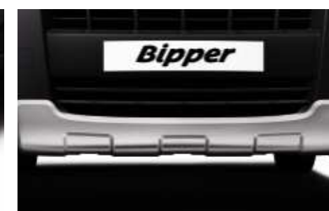
Protección bajo motor
